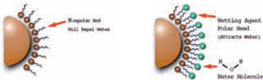
Abbildung 9: Anlagerung von Wasser an hydrophobem Material mittels Wetting Agent (Anonymus, ohne Jahreszahl, verändert, www.altera-research.nl)
